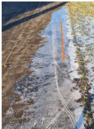
Figur 4: Exempel på hjulspår vid hard bromsning på halt underlag.
